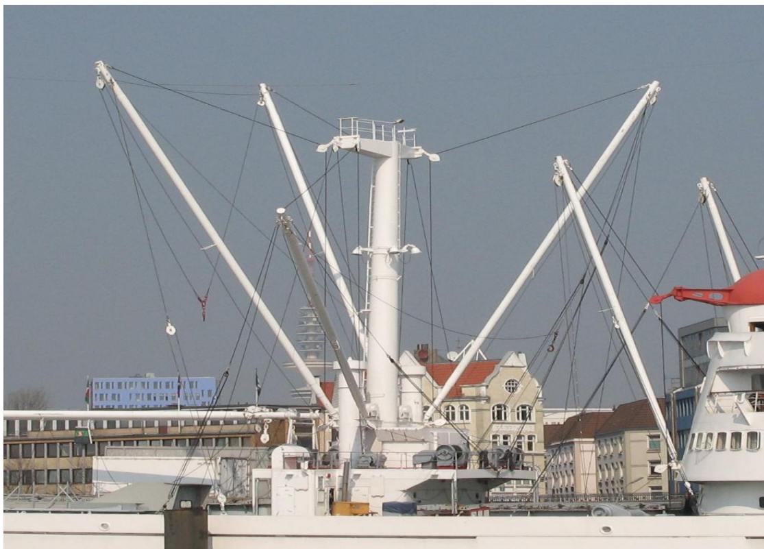
Figuur 19. Een laadbomen systeem met laadboom, geien, runners en winches.
